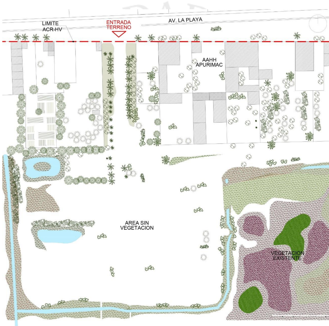
Figura 8.42 Levantamiento de la vegetación existente del terreno
