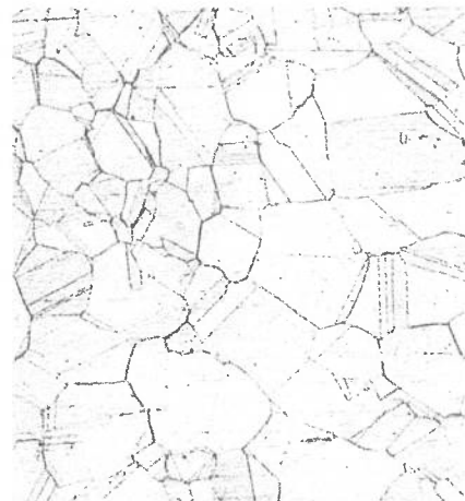
Microestructura del cobre desoxidado (DHP) inerte a la acción del hidrógeno.
