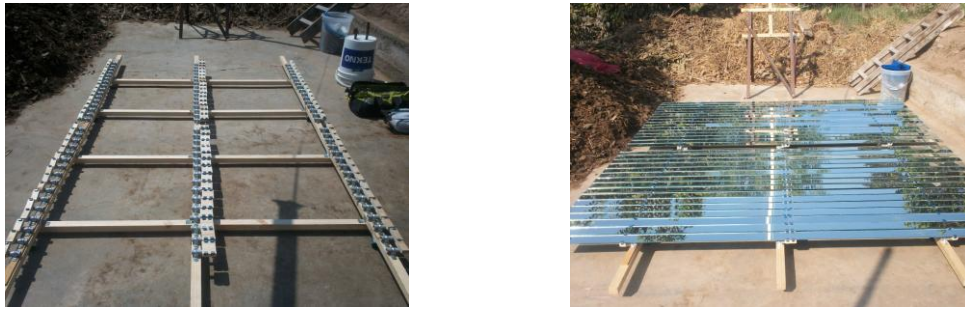
Figura 8 – Fotografías de la estructura de madera con las bisagras que soportan los espejos (izquierda), con los 32 espejos instalados (derecha).
