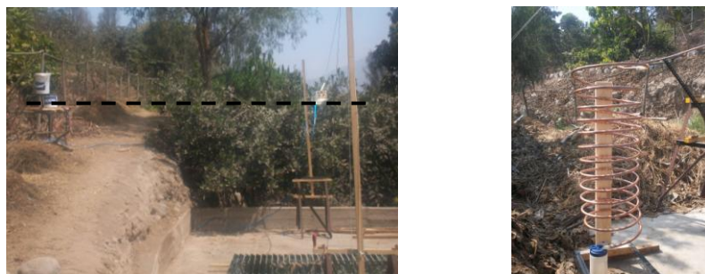
Figura 10 – A la izquierda se muestra una fotografía de los recipientes utilizados, la línea punteada muestra que el nivel del agua debe coincidir con la base del evaporador. A la derecha se muestra el enfriador utilizado.
