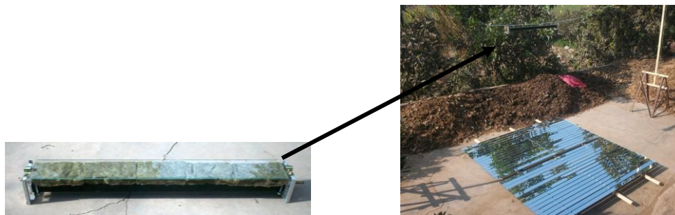
Figura 9 – A la izquierda se muestra una fotografía del evaporador. A la derecha se muestra el evaporador y los espejos instalados.
