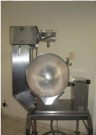
Figura 5.10 Marmita eléctrica enchaquetada de 120 litros
