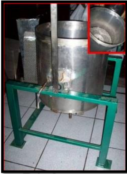
Figura 5.4 Lavadora de fruta de 500 Kg. de capacidad
