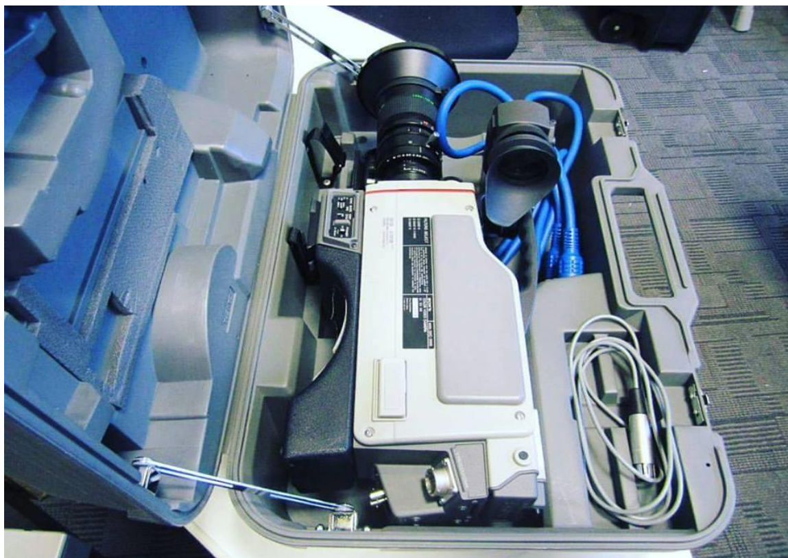
Ilustración 7 La histórica Cámara Sony DXC 3000 3 CCD. Especialmente diseñado para trabajo de prensa; tenía el peso, la óptica, visor grande y señal perfecta que se acomodaba a todo tipo de camarógrafos, inclusive se podía usar de trípode la cabeza del camarógrafo en situaciones. La mejor cámara con la cual trabajaje
