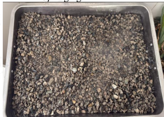
e) Se lava el material hasta que el agua quede cristalina
