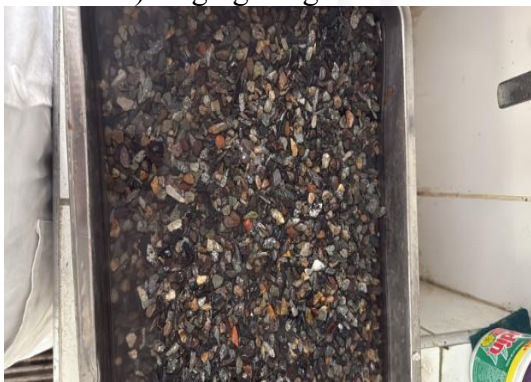
e) Se lava el material hasta que el agua quede cristalina
