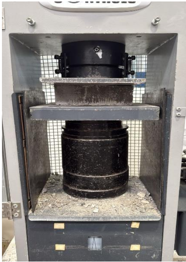
a) adoquín sometido al ensayo de resistencia a la compresión
