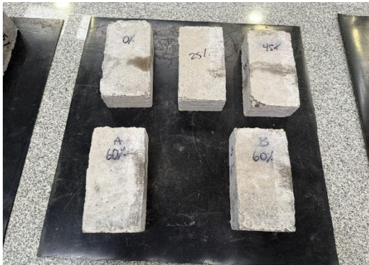
a) Adoquines sometidos al ataque químico con sulfato de aluminio
