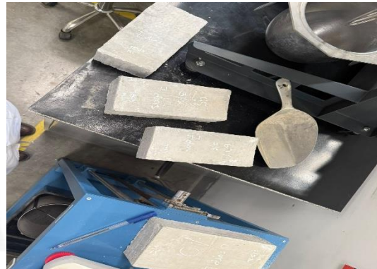
b) Adoquines en proceso de enfriamiento a temperatura ambiente
