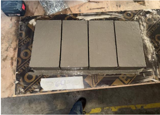
a) Adoquines inmediatamente después del desmolde
