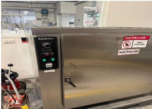
a) Proceso de secado de adoquines en horno a 105 \pm 5^\circ\text{C}
