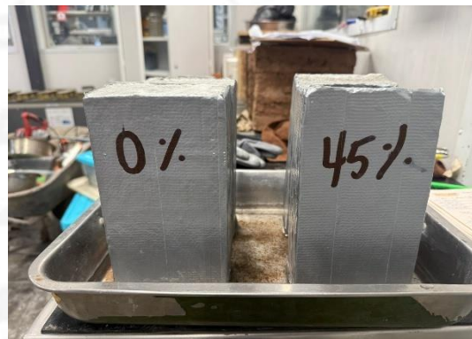
b) Adoquín durante el ensayo absorción de agua por capilaridad. Vista 2
