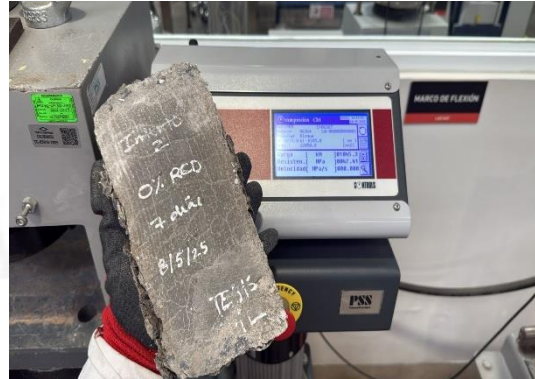
b) Adoquín de 0% RCD posterior al ensayo de resistencia a la compresión
