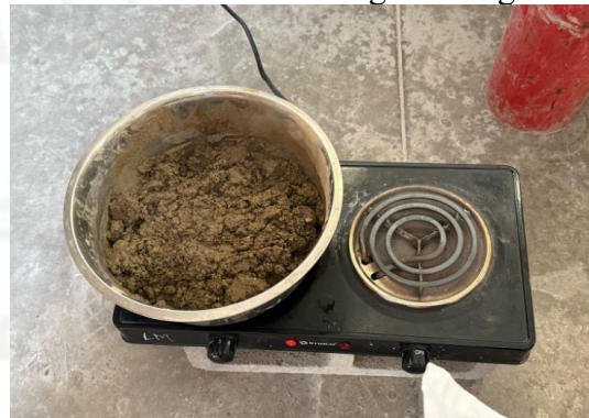
n) Secando la muestra en cocina para quitarle un poco la humedad
