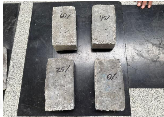
b) Adoquines sometidos al ataque químico con sulfato de magnesio
