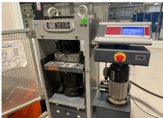
a) adoquín sometido al ensayo de resistencia a la flexión
