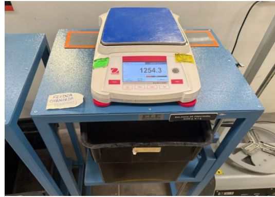
l) Peso del agregado piedra chancada húmedo sumergido en agua
