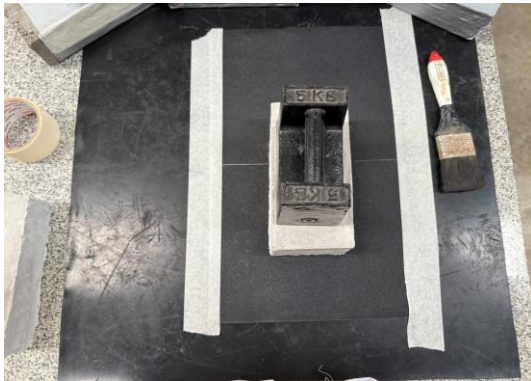
a) Adoquín durante el ensayo de abrasión manual. Vista 1
