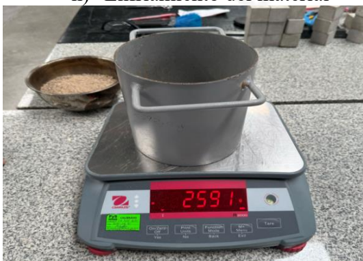
j) Proceso para calcular peso unitario suelto y compactado
