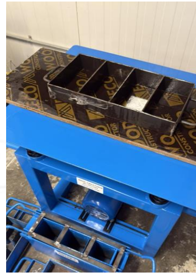
b) Mesa vibradora con los moldes para adoquines
