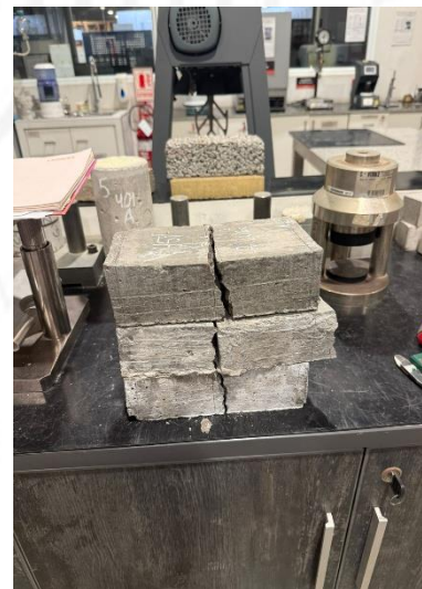
b) Adoquines tras el ensayo de resistencia a la flexión
