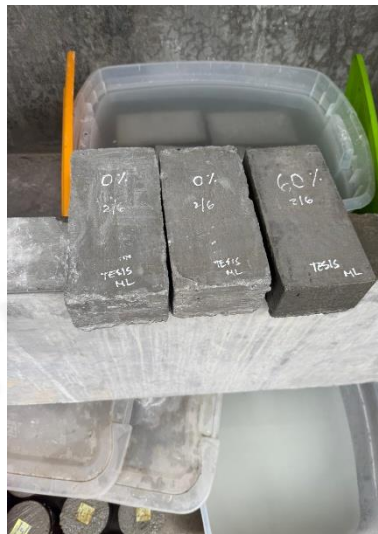
a) adoquín sometido al ensayo de humedad-secado
