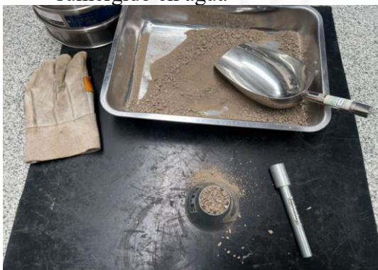
o) Ensayo de cono de arena para determinar la finura o la consistencia de la arena
