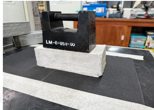
b) Adoquín durante el ensayo de abrasión manual. Vista 2
