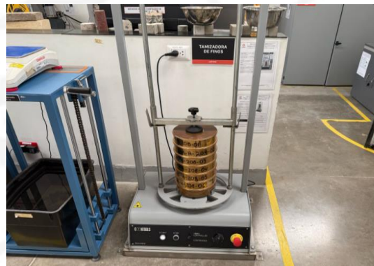
i) Proceso de tamizado en mallas
