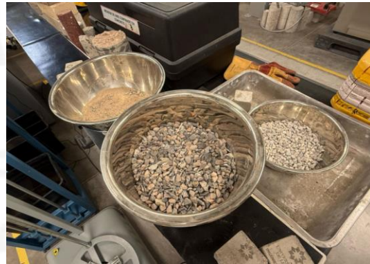
g) Retiro de muestras del horno
