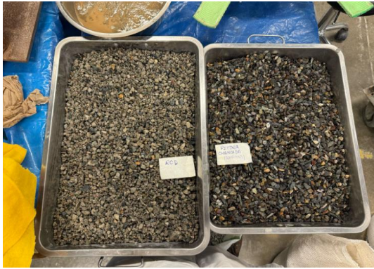
k) Proceso de secado de agregado grueso
