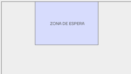
Zona de espera cada 50.00 m como máximo y deben disponer de mobiliario
