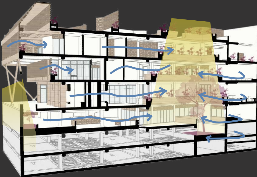
Figura 193 Nota: Corte perspectiva - Patio central como regulador térmico Fuente: Elaboración propia
