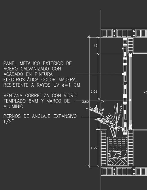
Figura 142 Nota: Instalación de paneles en uso exterior Fuente: Elaboración propia
