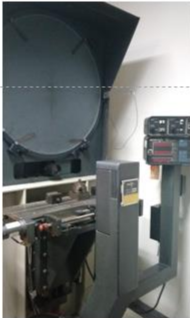
Medición en comparador óptico dimensiones críticas
