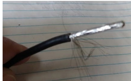
Cable blindado para evitar chispazos
