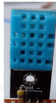
Sensor de Humedad/Temperatura
