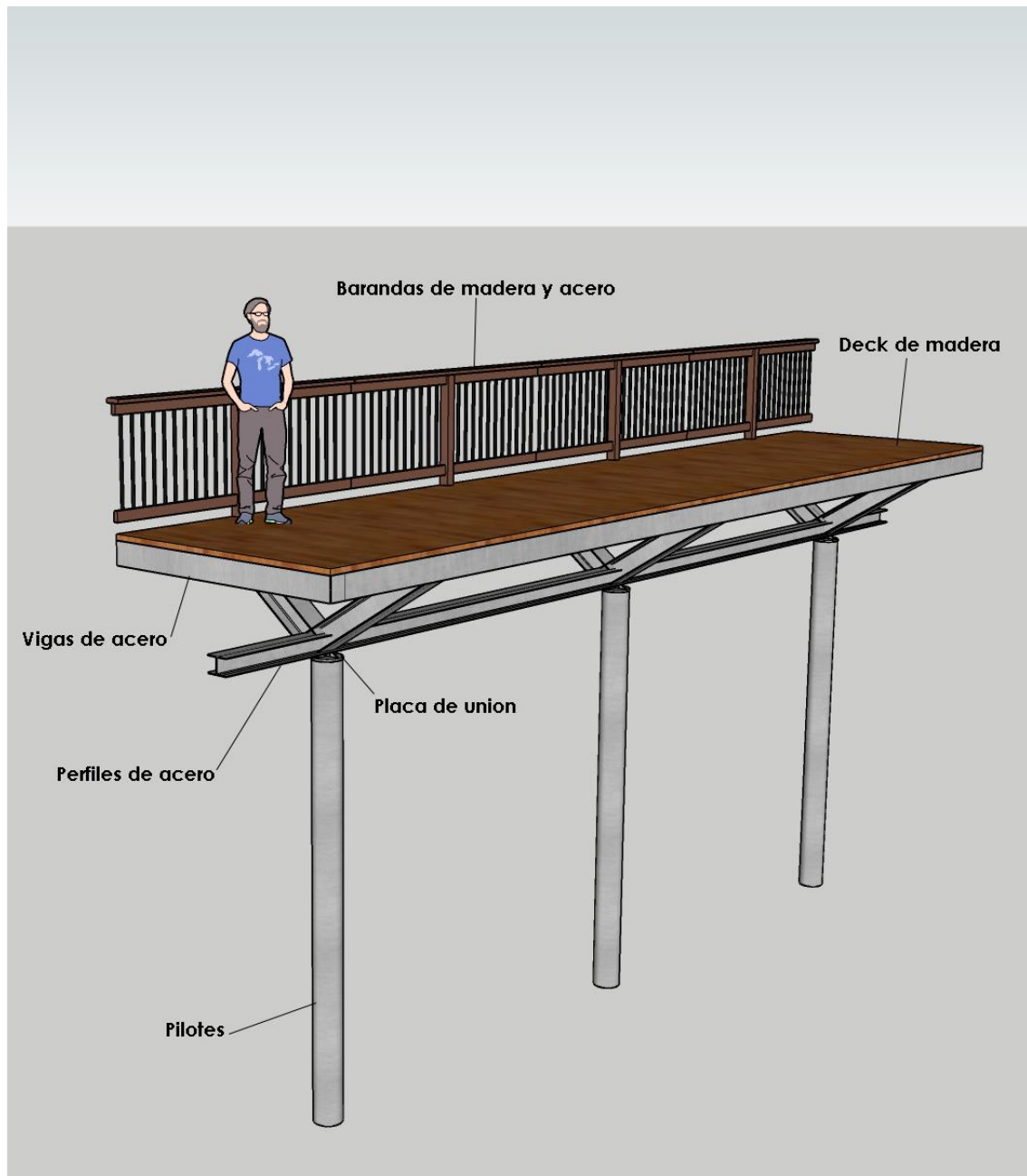
Figura 5.74 Detalle constructivo de Senderos Elevados
