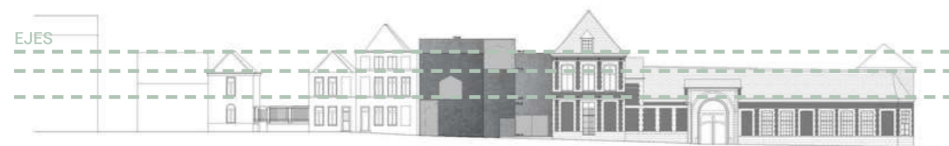
Imagen 65. Fachada posterior del proyecto: los ejes principales de la fachada se utilizan de guía para definir las aberturas. Fuente: Aires Mateus (2017)
